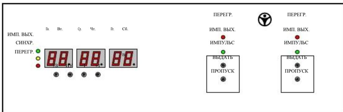
Рис. 1. Передняя панель первичных часов с усилителем импульсов
