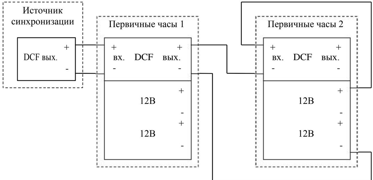
**Схема подключения источника DCF с выходом типа пассивная «токовая петля» к первичным часам:**
